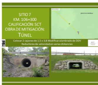
Definición de tipo de pasos de fauna y adaptación de estructuras en las carreteras
